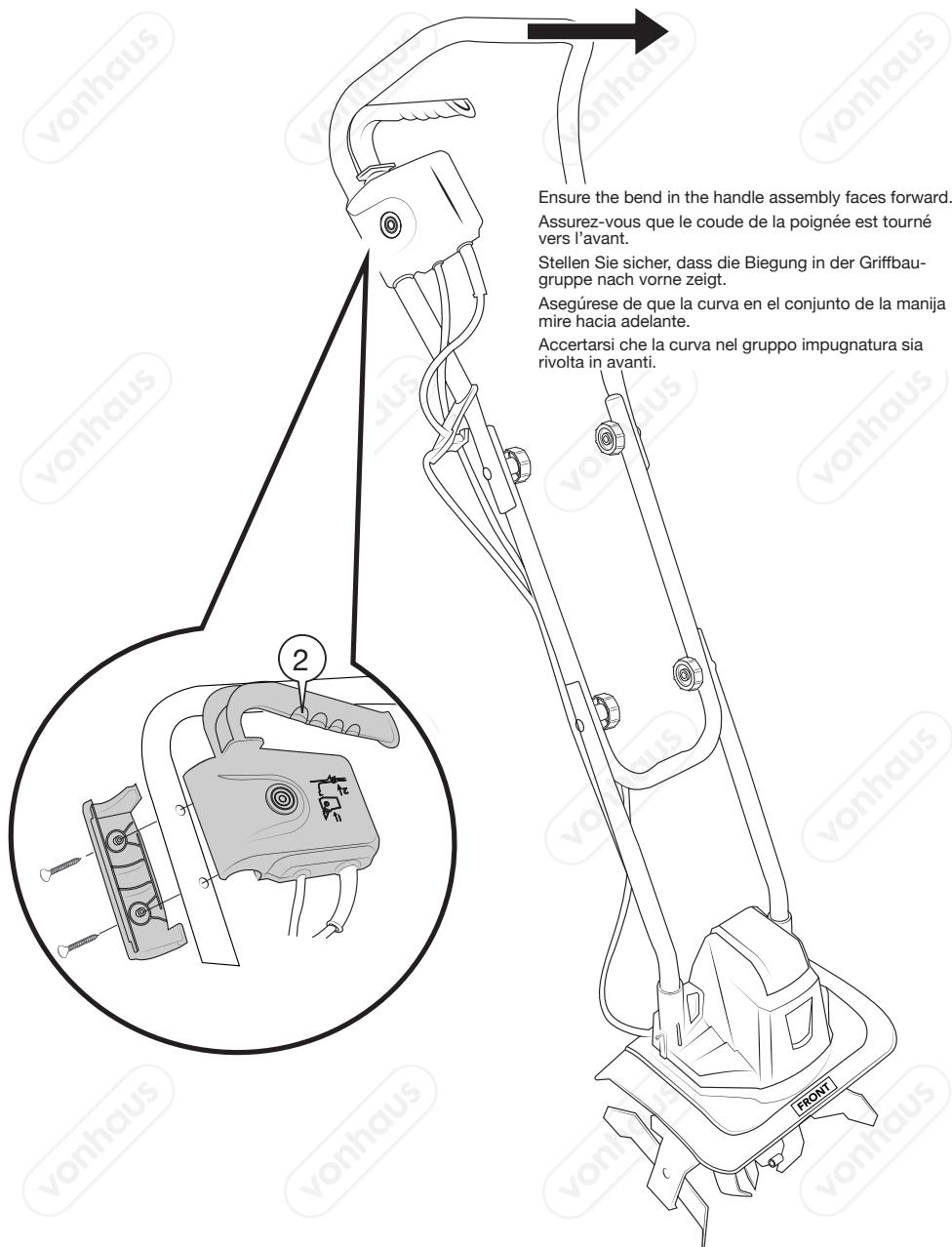
**USING THE CABLE RELIEF / UTILISATION DU DÉGAGEMENT DE CÂBLE / VERWENDEN DER KABELENTLASTUNG**
