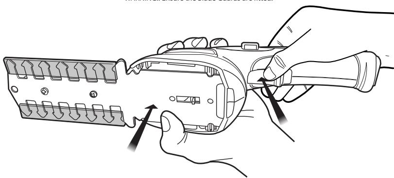
CHANGING THE BLADES / CHANGER LES LAMES / KLINGEN WECHSELN / CAMBIAR LAS CUCHILLAS /
