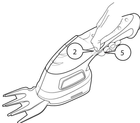
CHANGING THE BLADES / CHANGER LES LAMES / KLINGEN WECHSELN / CAMBIAR LAS CUCHILLAS /
